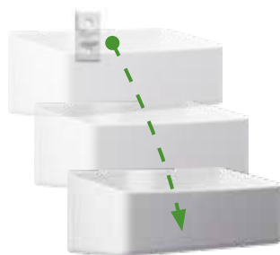
Hyllan släpper från väggfästet vid riskbelastning
